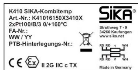
Beispiel Typenschild Ex-Bereich
