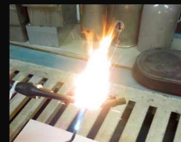
30-sekündiger Entflammbarkeitstest für die Zertifizierung nach DNV GL
